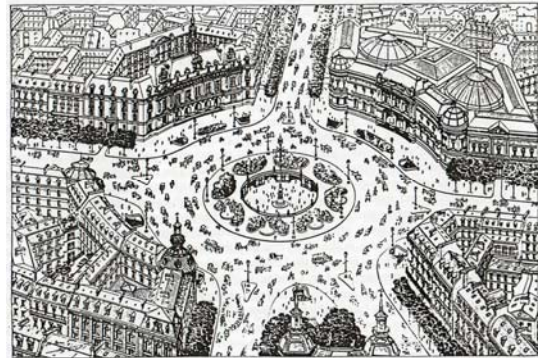
Figura 1. La propuesta pionera de Eugène Hénard para el “ Carrefour à giration ” de 1906 utilizada en la Place de l’Etoile desde 1907. Hasta entonces no había habido reglas de cómo debían funcionar los cruces de rutas, lo que significaba que las condiciones de los cruces más importantes eran caóticas. Debe destacarse que Hénard también intentó un nivel inferior para los peatones con diversas instalaciones; como sabemos tales arreglos se convirtieron en elementos del diseño de calles en el siglo XX, aunque rara vez los peatones utilizan el espacio del centro de la plaza, como Hénard había previsto. Entre otras ideas propuso dividir los pasos a nivel [de Evenson (1979)]
